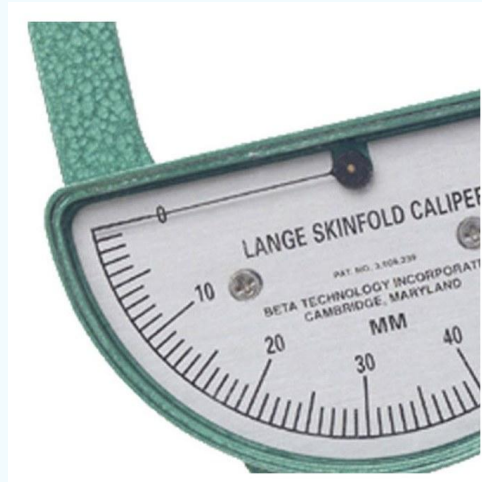
DIAL DE PRECISIÓN MM Escala 0–67 mm · 10 g/mm 2 constante
