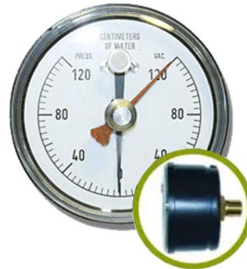
Manómetro NIF Meter Pimometer Zona roja (inspiratoria) · Zona verde (espiratoria) Flecha de retención de esfuerzo máximo
